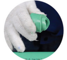
รูปการนูนขึ้นเป็นชั้นของข้อต่ออานม้าหลังจากการให้ความร้อน
